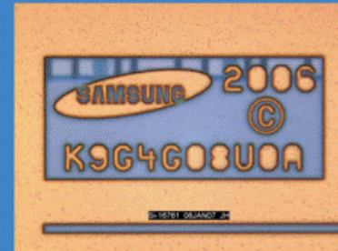
Samsung 65nm 4Gb MLC NAND Flash Die Markings
