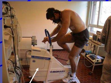
Bicyclette ergométrique permettant de mesurer la puissance mécanique produite
