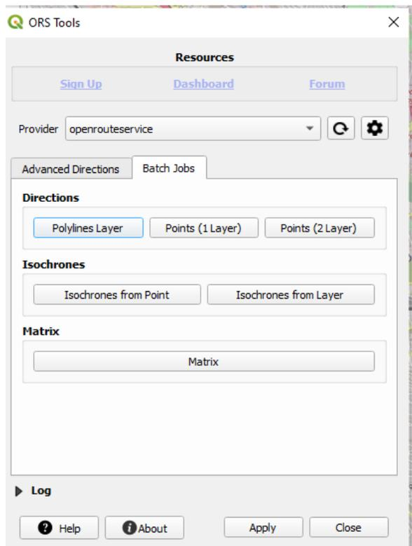
Sélectionner la molette de réglages afin de choisir la clef de l'API à choisir afin de réaliser le traitement :
